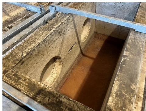
Příklad formy EASYBLOCK pro SCC beton
